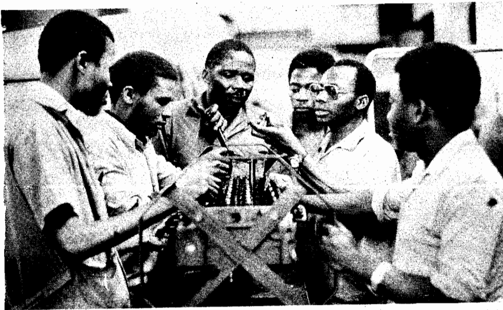
Estudantes trabalhadores em fase de desmontagem de um motor-diesel a dois tempos. O operário explica-lhes a função de cada peça
